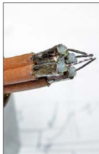
Bild 9: Die vier vorbereiteten RG179-Kabelenden vor dem Verlöten vor dem Verlöten mit dem Mittelstift der N-Buchse
