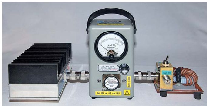
Bild 1: Transformator, Wattmeter und Lastwiderstand lassen sich hier einfach verbinden, weil sich die Steckverbinder auf gleicher Höhe befinden.
