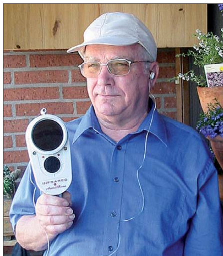
Bild 2: Durch die eingesetzten drei Monozellen ist das Astro Infraphon 6611 recht schwer. Wer es, wie hier DL8ZX, über längere Zeit wackelfrei ausrichten wollte, musste schon etwas üben.
