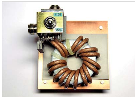
Bild 4: Die Zusammenschaltung der wenigen Bauteile ist schnell realisiert; oben auf dem Blech der Umschalter 22 Ω/110 Ω.
