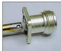
Bild 4: Die Verlötung erfolgt von außen durch das zuvor am Ende des Messingrohrs gebohrte Loch.
