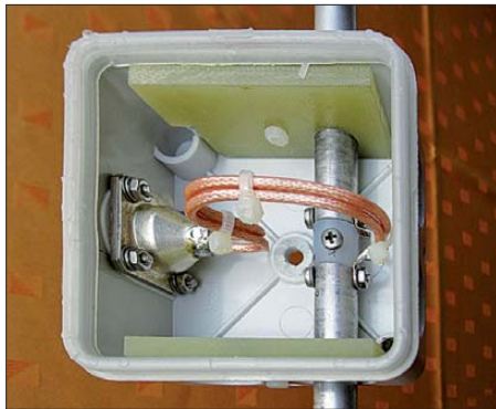
Bild 1: Anpassung mit zwei parallelgeschalteten 75-Ω-Viertelwellenstücken aus RG179; die auf der Lötseite der N-Buchse montierte Abschirmtülle bringt dort HF-mäßig eindeutige Verhältnisse.
