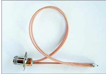
Bild 8: Diese Ausführung mit RG179 findet sogar noch im Boom-Rohr Platz.
