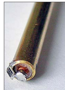
Bild 6: Zum Messen der Rückflussdämpfung ein am Ende der Anpassleitung aufgelöteter 27- \Omega -SMD-Widerstand
