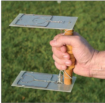
Bild 23: Versuchsaufbau einer Phasenpeilung ohne Laufzeitunterschied mit zwei Magnetantennen
