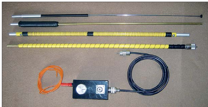
Bild 1: Zerlegte Reiseantenne für 40 m bis 10 m; von oben nach unten sind die Teleskopteile S2, die Verlängerungsspule L3 samt Messingstab S1 sowie die beiden Grundelemente L2 und L1 zu sehen. Darunter liegt die Anpassbox mit Radial und Koaxialkabel.
