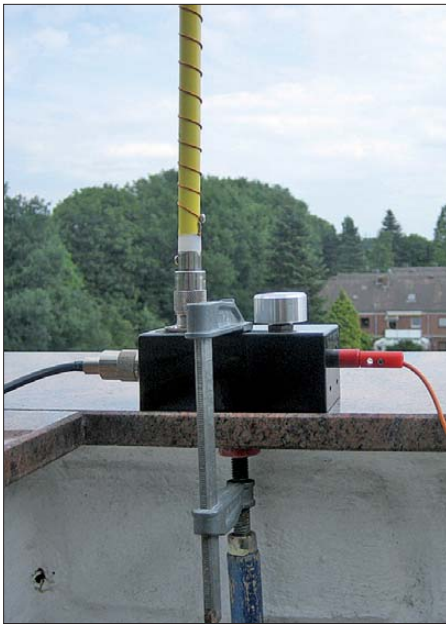
Bild 4: Um der doch recht langen Antenne die nötige Standsicherheit zu verleihen, wird die Abstimmbox mit dem darauf aufgesteckten Strahler einfach durch eine kleine Schraubzwinge auf eine vorhandene waagerechte Fläche geklemmt. Fotos: DK2UT
