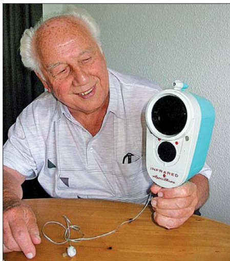
Bild 1: Das Lichtsprechgerät in der Hand von DF5NX könnte man beim ersten Blick für eine sogenannte Laserpistole halten, wie sie heute die Verkehrspolizei für Geschwindigkeitsmessungen verwendet.
