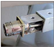
Bild 12: Die auf Maß gesägte N-Buchse erhält auf zwei rückwärtig gegenüberliegenden Seiten angelötete Blechstreifen.
