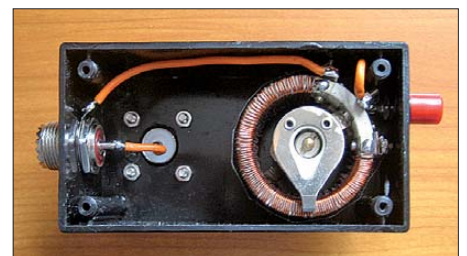
Bild 3: Als Spulenkörper dient ein altes abgewickeltes Drahtpotenziometer. Die Lack-schicht der neu aufgetragenen CuL-Wicklung ist auf der Schleiferseite zu entfernen.
