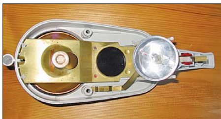
Bild 6: Vordere Gehäuseschale mit der Fotozelle nebst Reflektor links und dem nach hinten gerichteten Reflektor samt Glühlampe rechts
