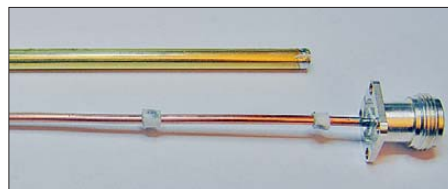
Bild 5: Prototyp des „schlanken“ 37,4- \Omega -Koaxialrohrs vor dem Zusammenbau; hier noch mit Zentrierstücken aus einem Schaumstoffdielelektrikum
