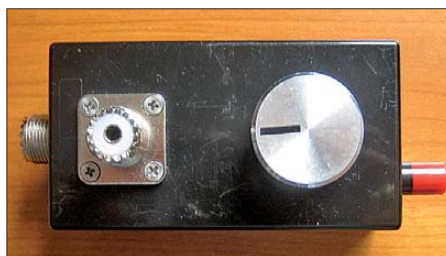
Bild 2: Sockel der Antenne mit der abstimmbaren Spule darin; je größer der Drehknopf ist, desto feinfühlicher lässt sich die Spule einstellen.
