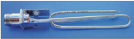
Bild 11: Symmetrier- und Transformations-Schaltung nach Bild 7 in der Ausführung mit einem 35-Ω-Koaxialkabel.
