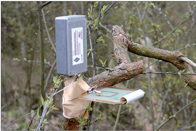
Bild 29: Die hier ohne Elektronik als Sendeanenne eingesetzte Platine des Peilers V 6.3 bei einer Fuchsjagd des DARC-OV Spandau
