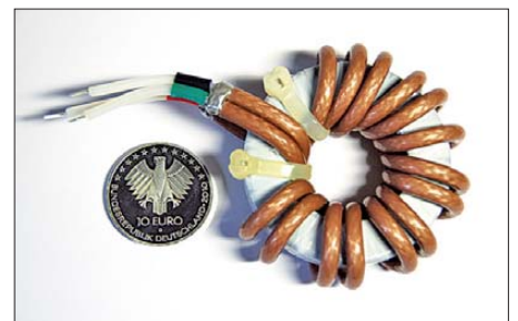
Bild 2: Handwerklich nicht leicht, aber machbar; die Bewicklung des Kerns mit Koaxialkabel des Typs RG142
