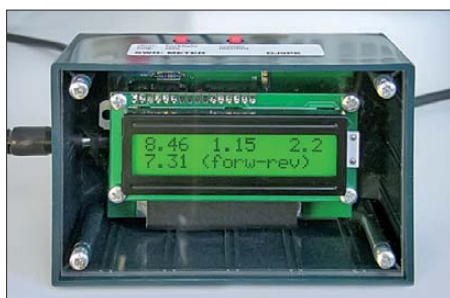
Bild 1: Fertig aufgebautes SWV-Meter von DJ9PK; das zweizeilige LC-Display zeigt die gemessenen und berechneten Werte an.
