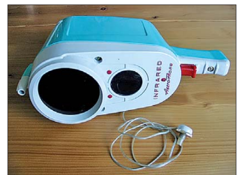
Bild 3: Außenansicht mit passendem Ohrhörer; die große Öffnung ist der Lichteintritt, der kleinere der Lichtaustritt. Das Röhrchen ganz links ist das Visier.
