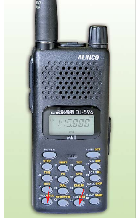
Das Handfunkgerät Alinco DJ-596 Mk II ist ein typischer Dualbander: nur ein Band anzeig- und einstellbar.
