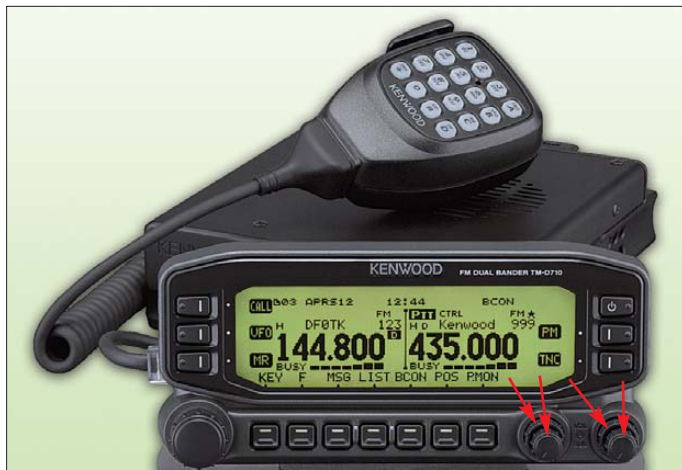
Das Mobilgerät TM-D710, von Kenwood „Dual Bander“ genannt, weist die typischen Merkmale eines Twinbanders auf: Zwei Bänder werden angezeigt; Lautstärke- und Squelch-Steller (Pfeile!) sind doppelt ausgeführt.
