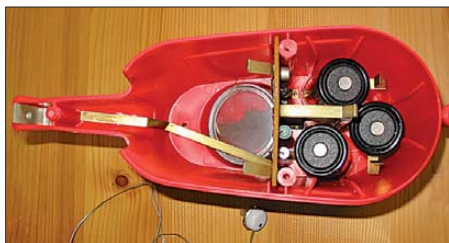
Bild 7: Hintere Gehäuseschale mit optischem Mikrofon links, senkrecht stehender Verstärkerplatine in der Mitte und Batterien rechts Fotos: DL8ZX
